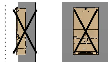
Afin que l'installation soit correcte, du jeu doit être présent entre la borne et les murs.
